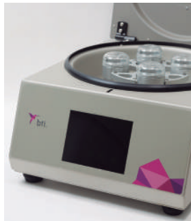
採血した血液を遠心分離させ、成長因子が多く含まれる血漿部位を取り出すPRGF機器。
