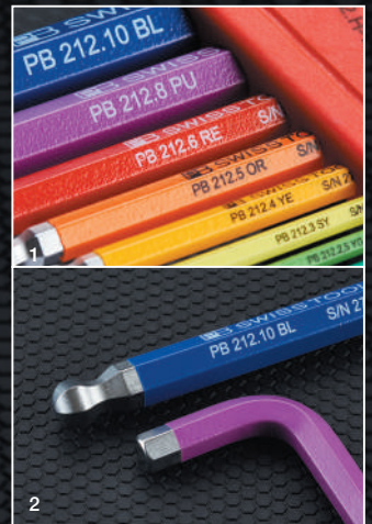
1.各レンチには生産番号が刻印され、原料段階から製造過程を追跡可能。高度な品質管理の証しだ。2.ボールポイントは、ボルトに対して30度までの角度なら回すことが可能。
