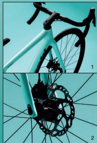
1. 流れるような空力フレームとケーブルの内装化がレーシーな雰囲気を醸す。2. 日常使いはもちろん、高速走行時にも安心できる油圧式ディスクブレーキ。
